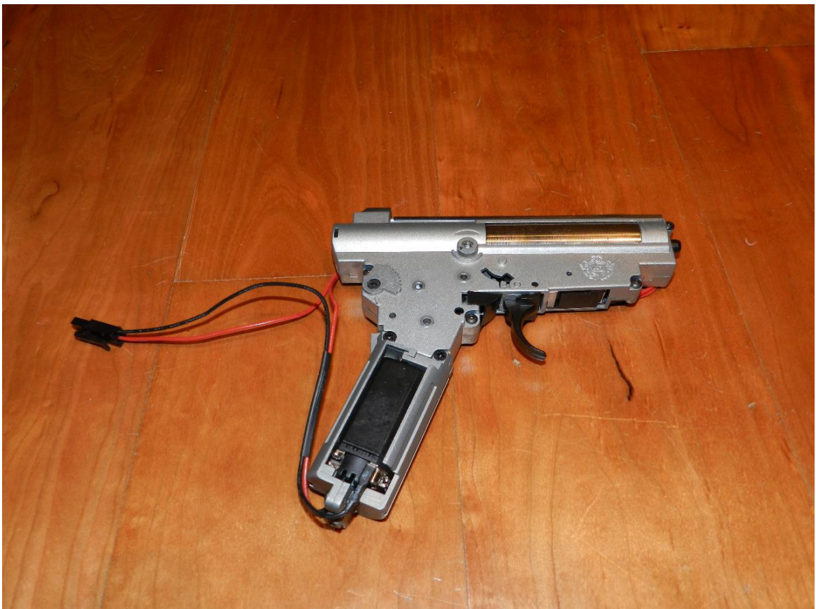
Gearbox versão III, geralmente montado em MP5Ke PDW, AK's, G36C, SIG's
